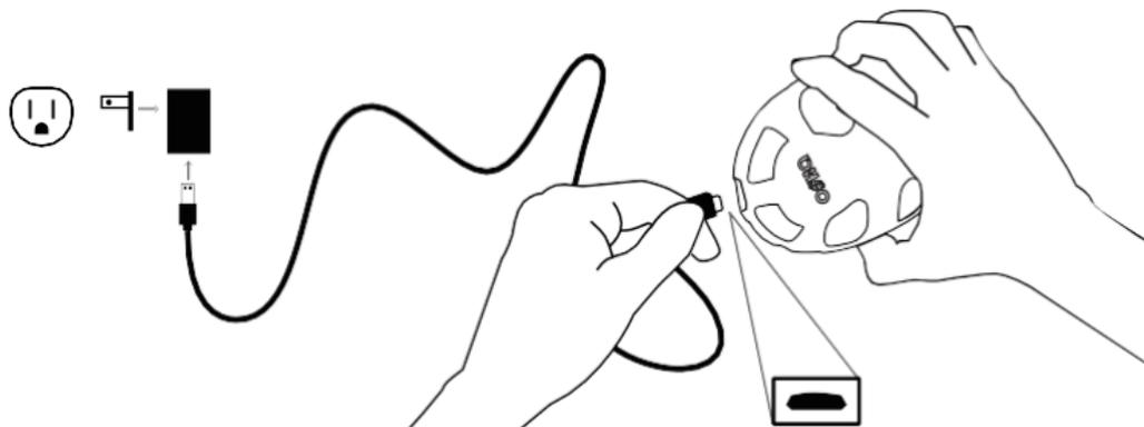
Подключите конец кабеля микро-USB к зарядному порту, расположенному на конце Oska Pulse.
